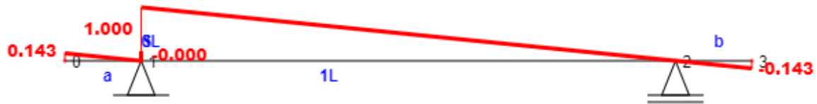
Figura 55 - Resultado gerado pelo programa da LI de Cortante no apoio do nó 1 pela direita
